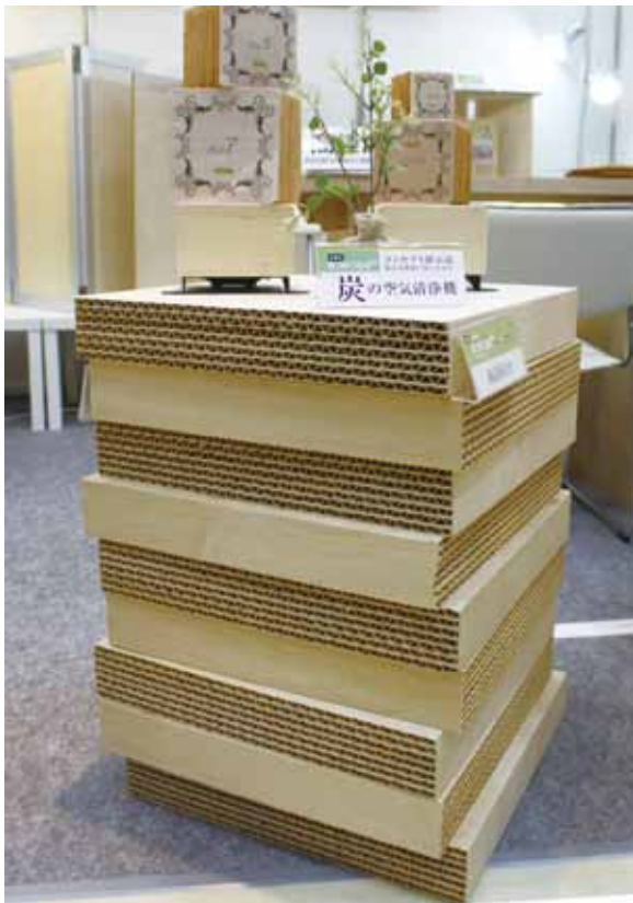
軽くて丈夫な“木のダンボール”はさまざまな用途が期待される
