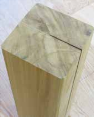
四方柱の床柱の木口。4面とも柱目になるよう大径丸太の芯を避けた目の詰まった所を斜めにして角材を挽く
