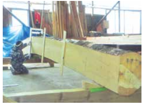
加工場で赤松の丸太から太鼓梁を木作りする
