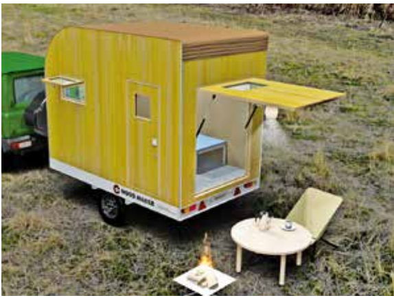
今井産業開発の木質段ボール「e・wood+」で製作した軽量のキャンピングトレーラー（CG）
