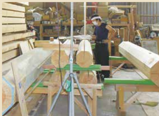
大山建工の加工場で加工されるアカマツの八角形の丸太梁
