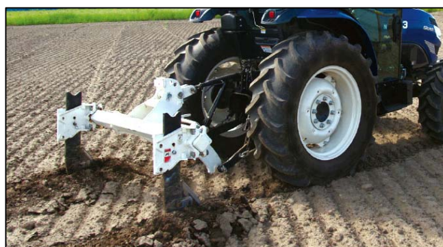
サブソイラによる作業状況
