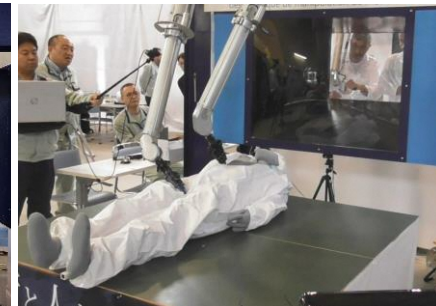
オラノ社運転員の操作の様子 (マネキンに対し遠隔で防護服着用)
