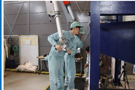
当社運転員の操作の様子 (マニピュレータを2人で操作)
