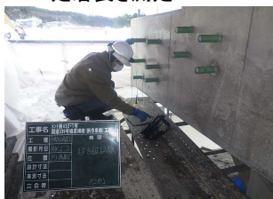
超音波測定器による 定着長さ測定
