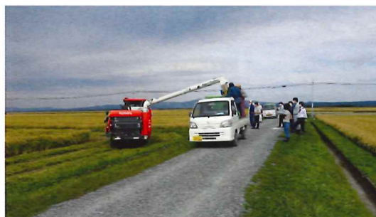
④収量センサと位置情報で糞満タンを予測し、設定され た搬出ポイントに自動で移動する。搬出は手動
