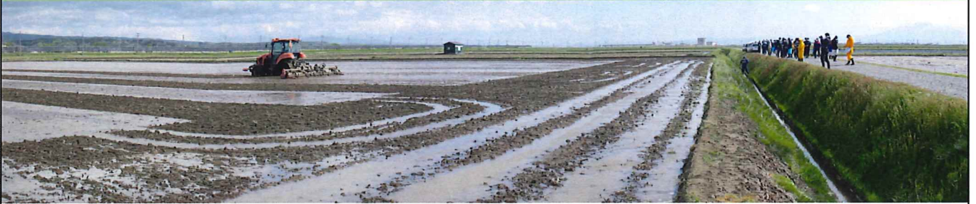
ロボットトラクタMR1000AQMAXWUPC-3による大区画水田での代かき作業の実演風景 間接ターンの走行状況が見えるように荒代かき作業で実施（R2年5月13日）
