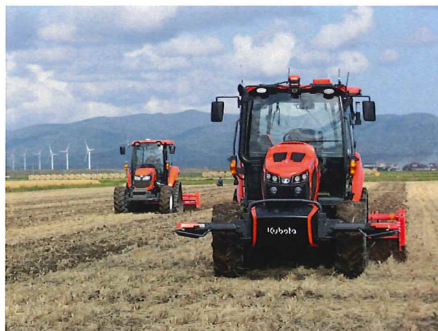
ロボットトラクタMR1000AQMAXWUPC-3と 既存トラクタMR97+自動操舵システムCFX-750 の協調作業
