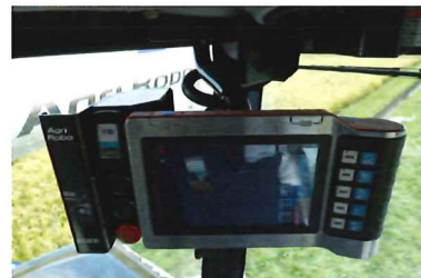
ターミナルモニター (自動運転アシストの設定)
