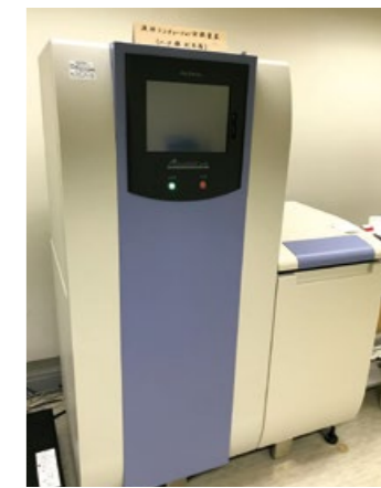
液体シンチレーション計数装置 (トリチウムの計測装置)
