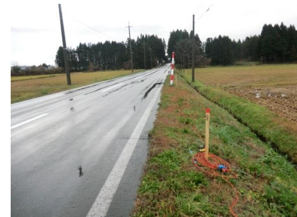
図5 受振器の設置状況(事例)
